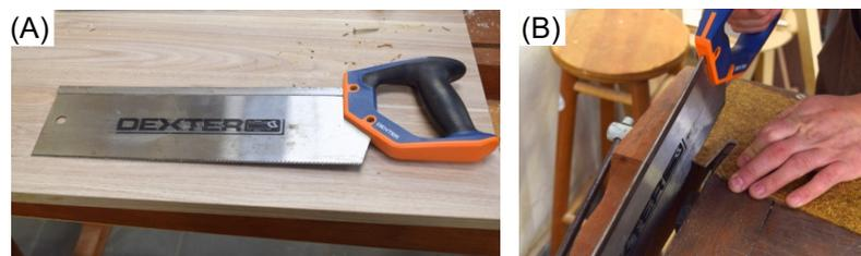
Figura 2: Serrote: A) Serrote e B) Realização do corte na placa de compósito.
