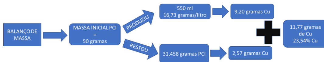
Figura 24 – Balanço de massa do cobre a partir de 50 gramas de PCI.
