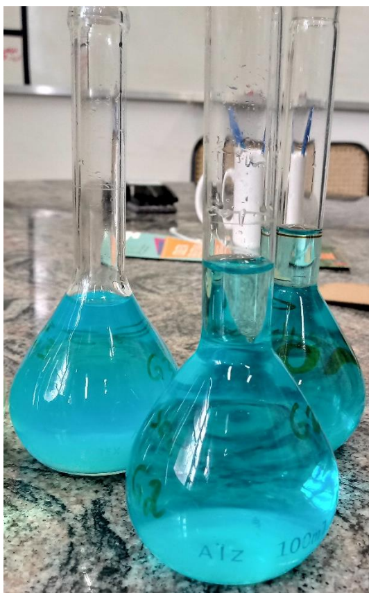
Figura 22 – Lixivia das PCIs com ácido sulfúrico em conjunto com peróxido de hidrogênio.
