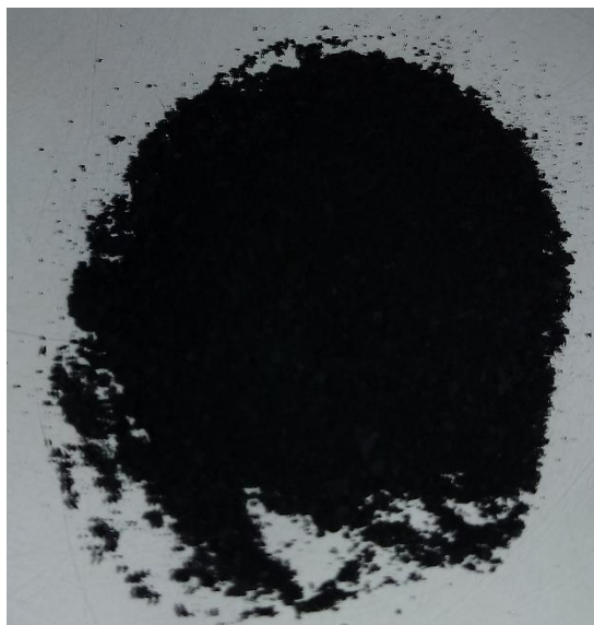
Figura 30 – Pó de cobre oxidado após 2 horas em temperatura de 700°C.
