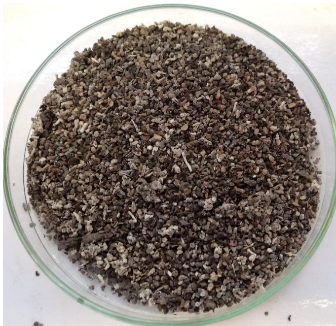
Figura 23 – Placas Circuito Impresso ao final da segunda lixiviação.
