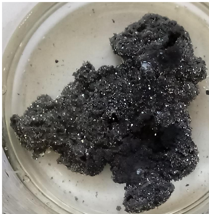
Figura 19 – Chumbo produzido com adição de resíduo contendo zinco do Tipo 1.
