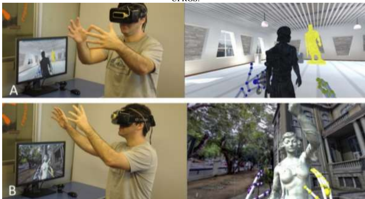
Figura 5: Imagem do usuário (à esquerda) e o que ele está vendo (à direita). (A) Exemplo de manipulação do modelo 3D da Estátua do Laçador. (B) Manipulação da estátua localizada no prédio do antigo Instituto de Química Industrial da UFRGS.
