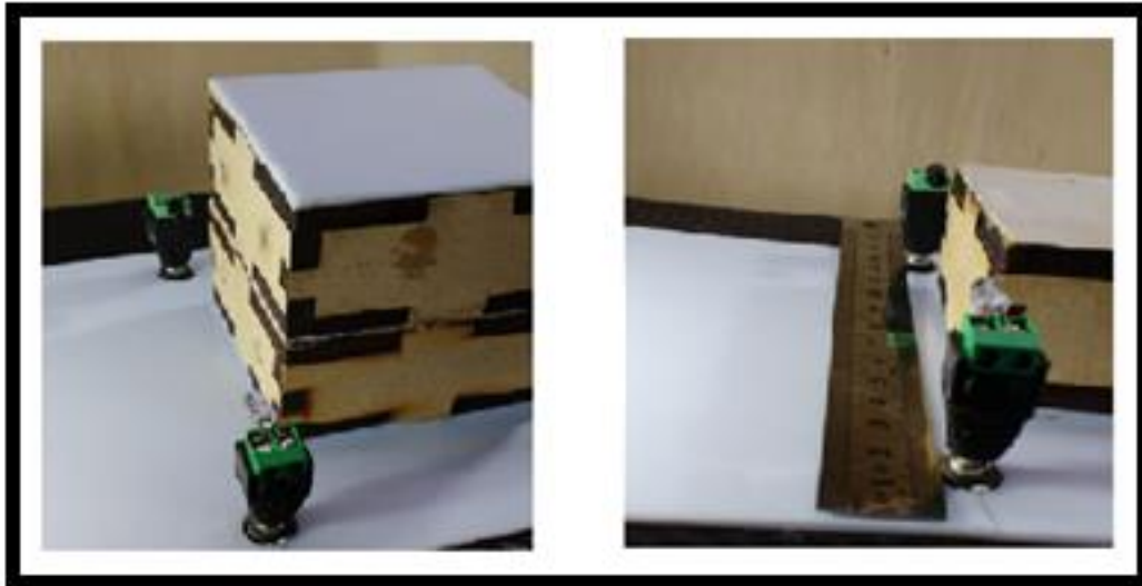
Figura 07 – Conjunto para detecção de movimento diodo emissor-receptor
