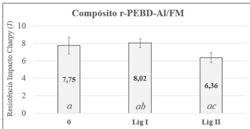
Figura 10: Resistência ao impacto Charpy dos compósitos avaliados.
