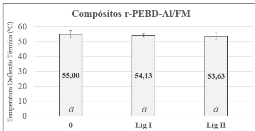
Figura 12: Temperatura de deflexão térmica dos compósitos avaliados.
