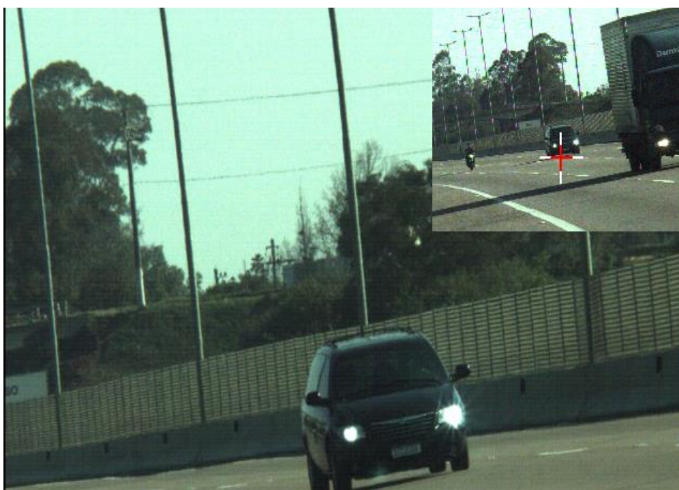
Figura 23 - Fotografia de radar com placa ilegível.
