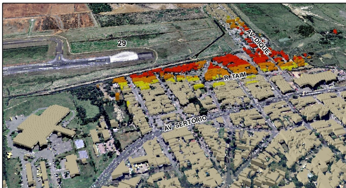
Figura 31 – Risco dos obstáculos próximos à cabeceira 29 da pista do aeroporto.
