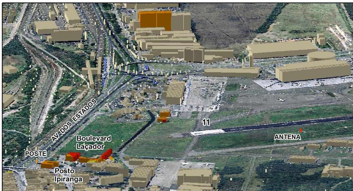
Figura 30 – Risco dos obstáculos próximos à cabeceira 11 da pista do aeroporto.
