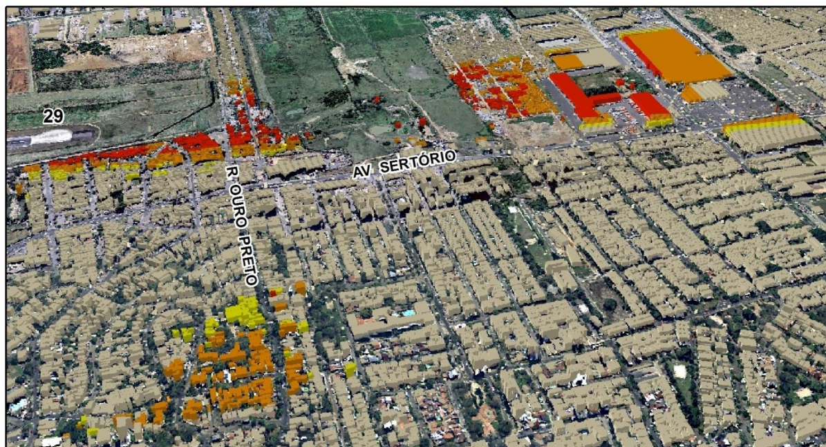
Figura 32 – Risco dos obstáculos próximos à cabeceira 29 da pista do aeroporto.
