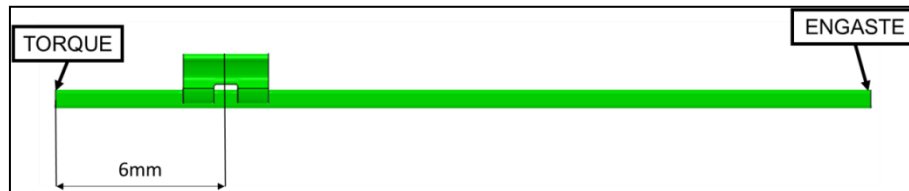
Figura V: Condição de contorno e região de aplicação de torque.
