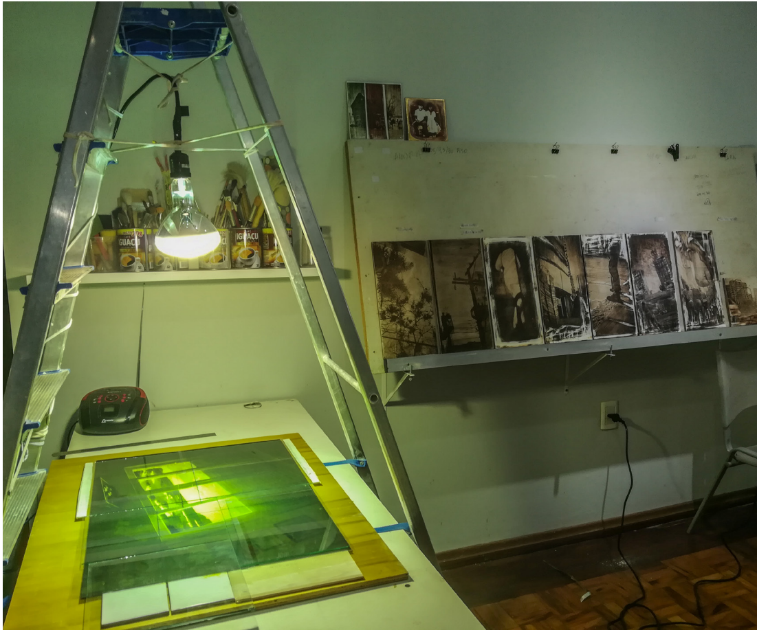
Figura 2: Exposição do azulejo com lâmpada ultravioleta
