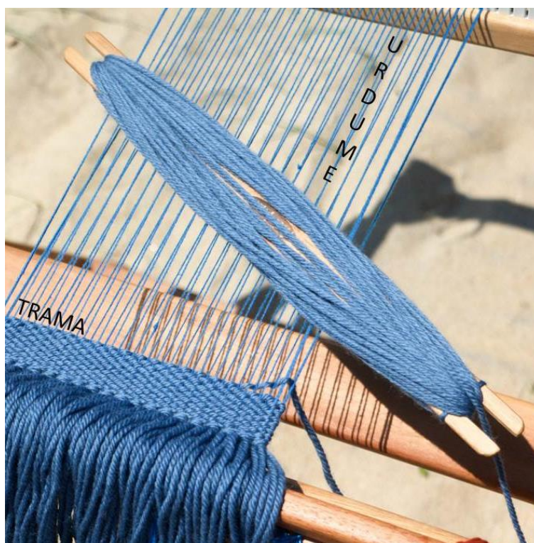
Figura 3 – Imagem de tear com urdume e trama Fonte: Scheila Eggert.
