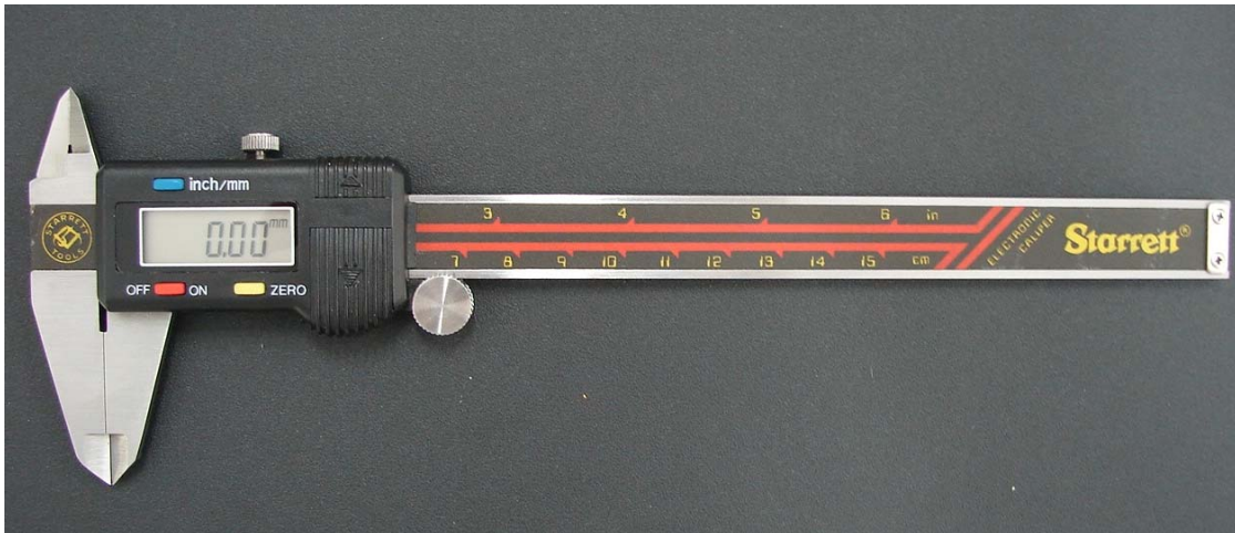
Figura 1: Paquímetro digital da marca Starrett.®.
