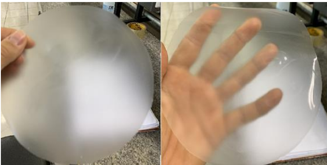
Figura 12 – Frente e verso do filme obtido com 3% de nanofibras de celulose bacteriana.
