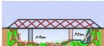
Como se vê, o pilar mais longo, de comprimento  $L_1 = 40$  m, possui coeficiente de dilatação linear  $\alpha = 18 \cdot 10^{-6} / ^\circ C$ . O pilar mais curto tem comprimento  $L_2 = 30$  m. Para que a ponte permaneça sempre na horizontal, determine o coeficiente linear do material do segundo pilar.
