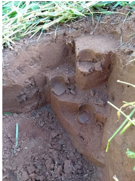
Figura 3. Esquema de coleta das amostras indeformadas nas três camadas de solo avaliadas.
