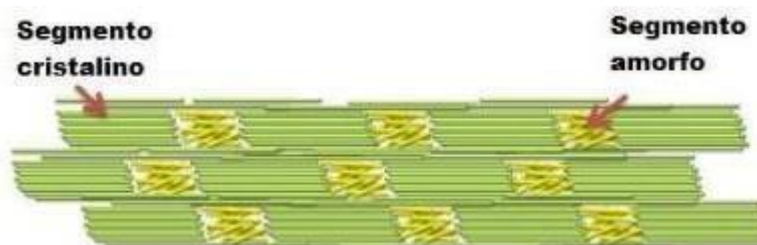
Figura 3 - Modelo para a estruturação das fibras de celulose em regiões amorfas e cristalinas.
