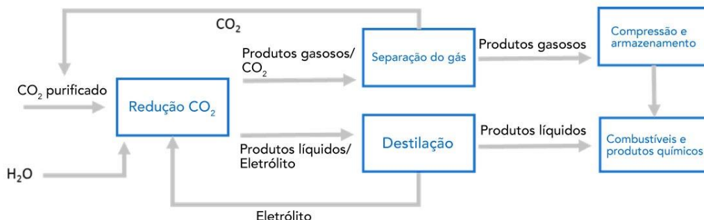
Figura 8: Diagrama de processo para redução eletroquímica de CO 2 .
