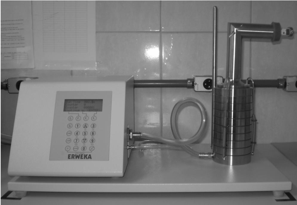
Figura 3. Impactador em Cascata de Andersen com 8 estgios j com porta de induo e atuador acoplados.
