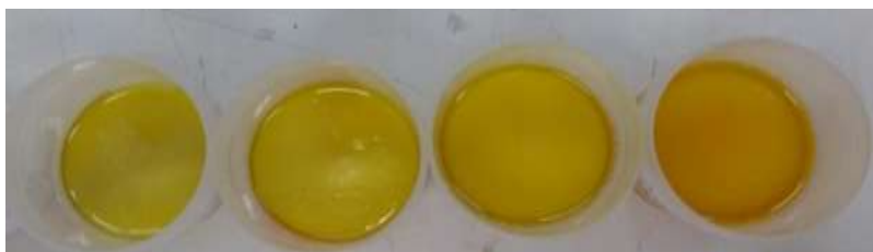
Figura 18: Biodiesel obtido a partir do mecanismo de transesterificação simples após congelamento usando como matéria-prima, da esquerda para a direita: sebo 3:1 soja, sebo 1:1 soja, sebo 1:3 soja, sebo 0:1 soja.
