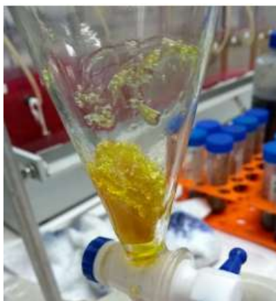
Figura 12: Sabão formado na reação de transesterificação utilizando uma mistura de sebo bovino 1:1 óleo de soja.
