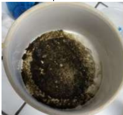
Figura 14: Sólidos resultantes das reações de esterificação seguido por transesterificação (II) de sebo bovino após serem filtrados.
