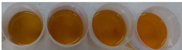
Figura 17: Biodiesel obtido a partir de transesterificação simples (I) usando como matéria-prima, da esquerda para a direita: sebo 3:1 soja, sebo 1:1 soja, sebo 1:3 soja, sebo 0:1 soja.
