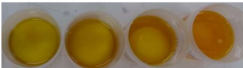
Figura 19: Biodiesel obtido a partir do mecanismo de transesterificação simples (I) após descongelamento usando como matéria-prima, da esquerda para a direita: sebo 3:1 soja, sebo 1:1 soja, sebo 1:3 soja, sebo 0:1 soja.
