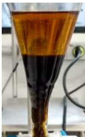
Figura 13: Biodiesel (camada superior) de sebo obtido por esterificação seguido por transesterificação (II) e sólidos decantados.
