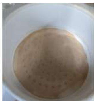
Figura 15: Sólidos resultantes da reação de transesterificação em duas etapas (II) do sebo bovino.
