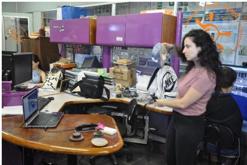
Figura 24 - Digitalização de uma Azaleia com escâner Artec EVA.
