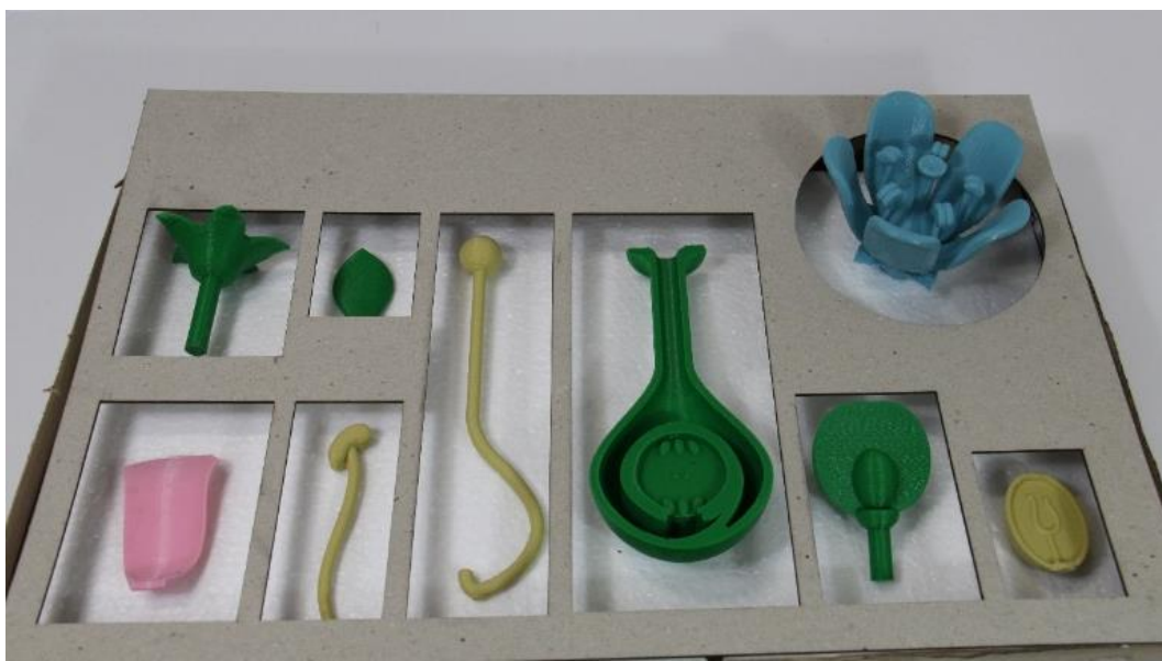
Figura 45 - Mock-up inicial do Conjunto de Peças Individuais contendo as peças impressas em 3D fabricado por corte a laser
