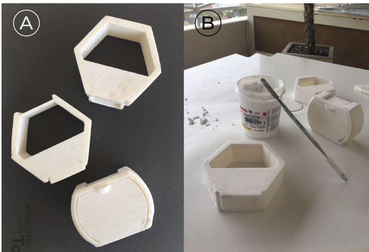
Figura 59 - Peças lixadas após impressão 3D (A), aplicação de tapa furo (B).
