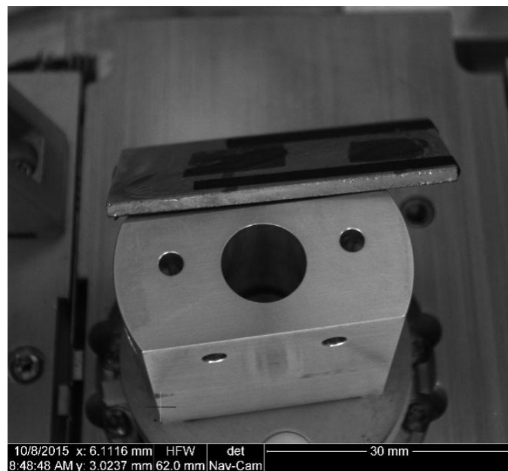
Fig. III. 13 - Lâmina petrográfica orientada a 75 graus do feixe de raios X sobre porta-amostras do MEV/FEG do Centro de Microscopia e Microanálise da PUC/RS.
