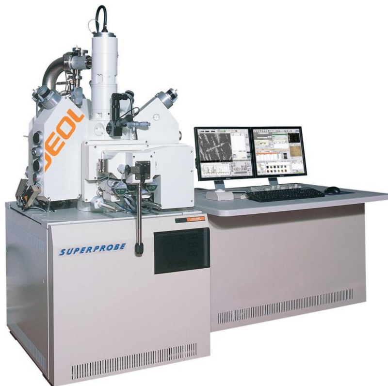
Fig. III. 8 - Microsonda eletrônica da marca Jeol, modelo JXA-8230, do Instituto de Geociências, UnB.
