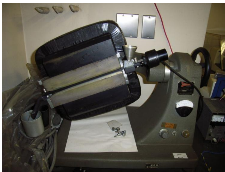
Fig. III. 1 - Separador Isodinâmico Frantz. A amostra moída é colocada no cone e passa pelo eletroímã que separa frações com diferentes susceptibilidades magnéticas.
