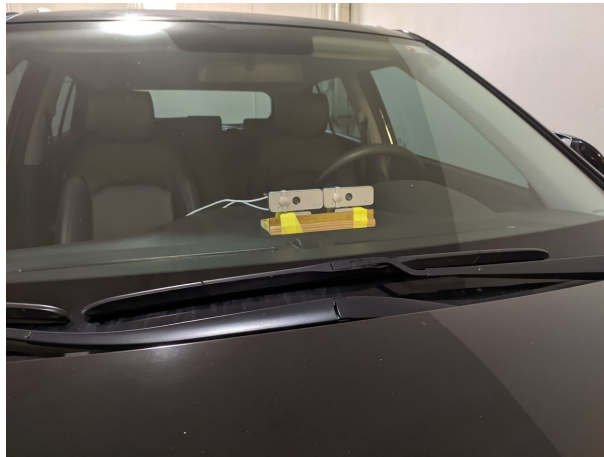
Figura 19 – Sistema de câmeras estéreo montado sobre o painel de um veículo.
