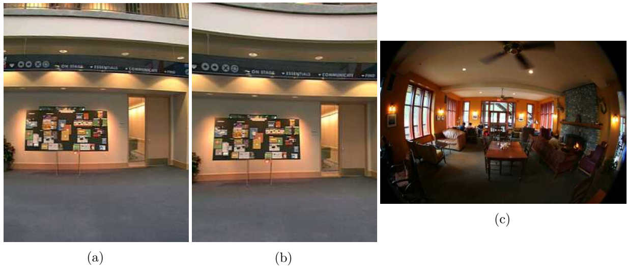
Figura 7 – Exemplos de distorção de lentes
