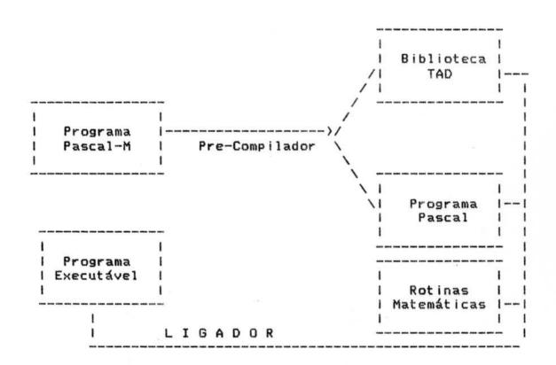
A partir do esquema acima pode-se notar que o Pré-Compilador vai dividir o programa original em dois: um que contém as rotinas correspondentes aos TADs e outro que contém a parte restante, no qual todos os comandos de Pascal-M são substituídos, conforme veremos adiante, por rotinas q ue executam a operação
