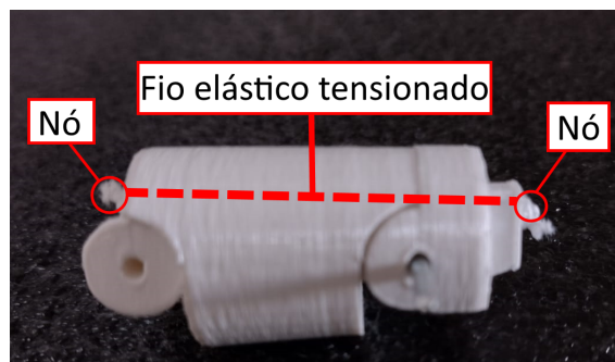
Figura 21: Montagem da prótese entre falange medial e distal.
