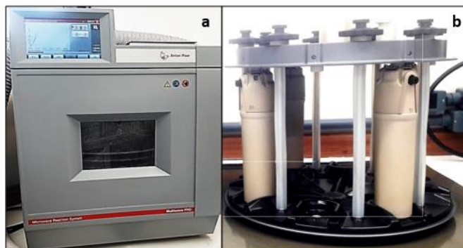
Figura 5 – a) Forno de Micro-ondas MultiwavePRO. b) Rotor com capacidade máxima para 8 frascos de quartzo
