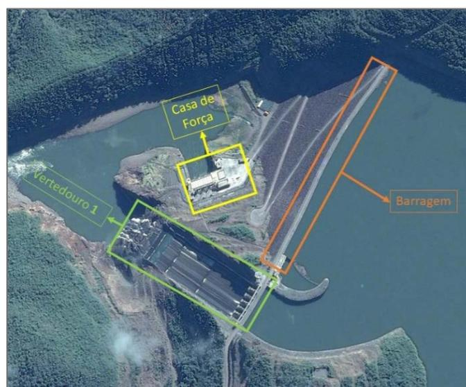
Figura 5-3. Arranjo geral da UHE
