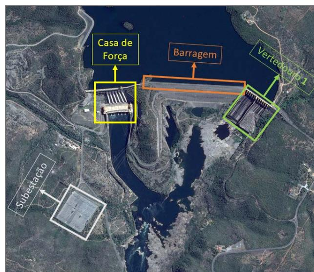
Figura 5-7. Arranjo geral da UHE Xingó
