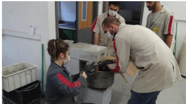
Após três minutos de mistura, parava-se o procedimento e, com uma parte da mistura, eram realizados os testes de índice de consistência (NBR 13276, 2016), os diâmetros estão apresentados na Tabela 13. Além disso, era realizada a moldagem dos corpos de prova cilíndricos utilizados no ensaio de resistência à compressão. A Figura 66 (a e b) mostra os procedimentos de ensaio de determinação do índice de consistência.
