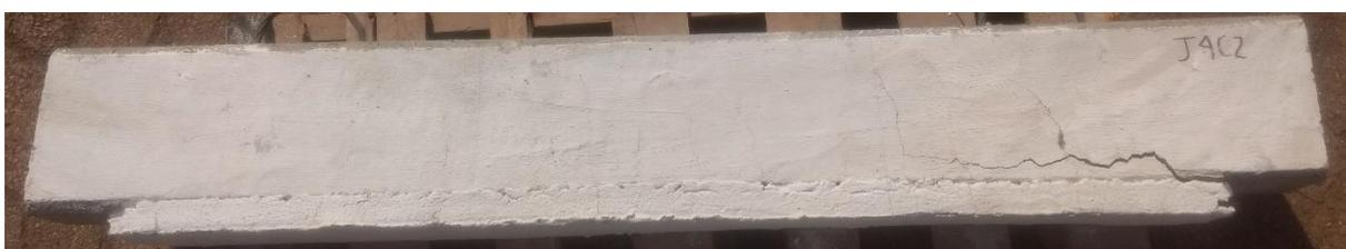
**Figura 99** – Viga J3V1 após ruptura por deslizamento do têxtil na matriz e ruptura do têxtil.
