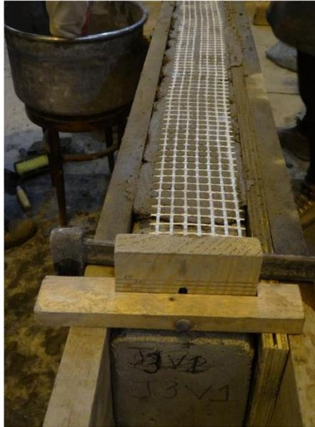
**Figura 70** – Elevação do sistema limitador de camadas.
