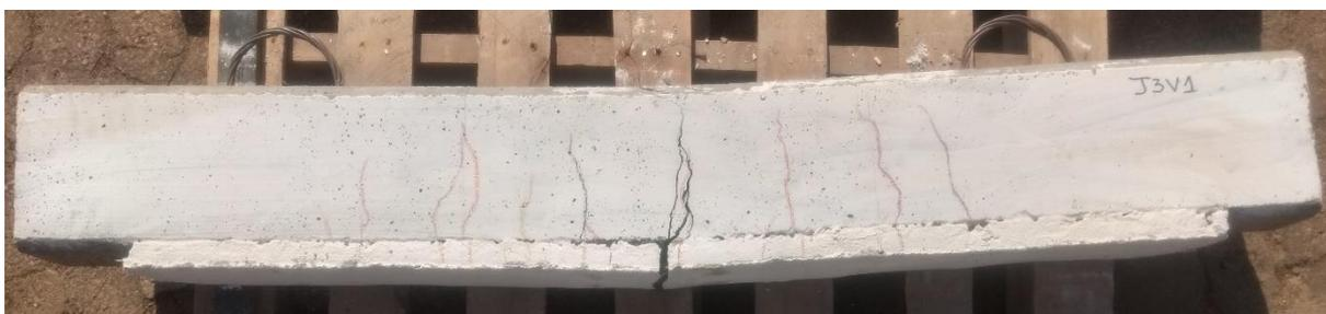
**Figura 100** – Viga J4V1 após ruptura por deslizamento do têxtil na matriz e ruptura do têxtil.
