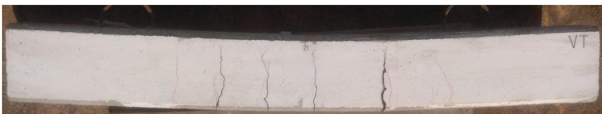
As vigas com tratamento superficial por apicoamento apresentaram o mesmo modo de ruptura: descolamento do CT do substrato de concreto. As vigas apicoadas rompidas estão apresentadas nas Figuras 86 a 93. Quando se verificava a falha na interface entre o reforço e a viga, o ensaio era interrompido, pois o reforço não estava mais ativo (resistindo aos esforços de tração).
