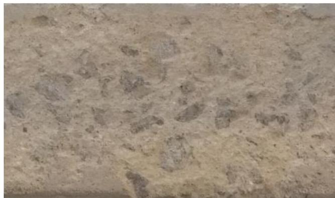
O apicoamento de oito das quinze vigas a serem reforçadas neste estudo foi executado no LEME, usando-se martetele elétrico. O procedimento foi realizado em dois dias por dois operadores diferentes. Pode-se verificar um registro do preparo da superfície das vigas apicoadas na Figura 57.
