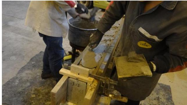
Após a aplicação e o nivelamento da primeira camada de argamassa, posicionava-se uma tira de têxtil sobre esta (Figura 69), e com uma peça de metal, eram dados leves golpes na área com o têxtil para que a argamassa penetrasse nos vazios da malha. Assim, o sistema limitador de camadas era elevado para limitar a camada seguinte (Figura 70), sendo aplicada a camada de argamassa seguinte.
