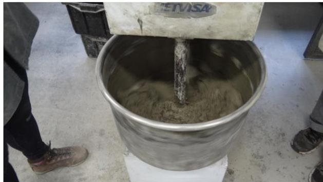
**Figura 65** – Adição de água na argamassa seca.
