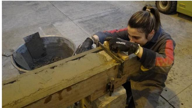
Os procedimentos – de elevar o sistema limitador de camadas, arremessar a argamassa, pressionar as pequenas quantidades de mistura, nivelar a camada, posicionar a fibra, pressionar com leves golpes, aplicar a camada seguinte – foram realizados até a última camada de argamassa.
