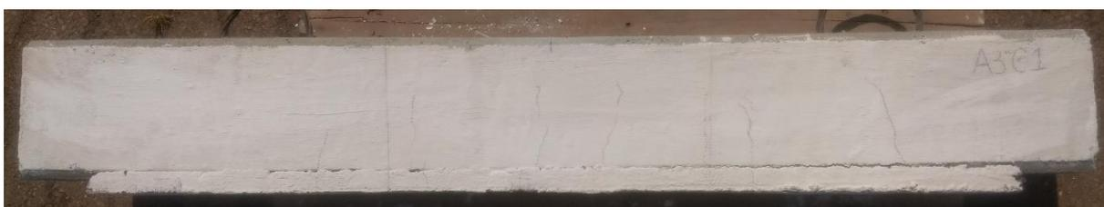
**Figura 87** – Viga A3C2 após ruptura por falha na interface reforço-viga.
