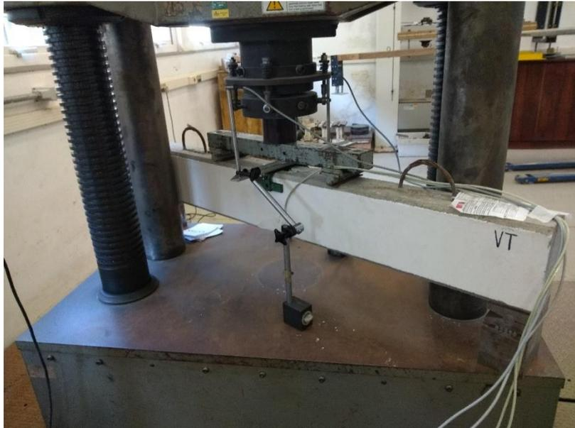
Os ensaios realizados foram de flexão a quatro pontos, com velocidade de aplicação de carga de 1 mm/min. O ensaio foi registrado por vídeos em uma câmera fotográfica, acompanhando-se o desenvolvimento da fissuração do reforço e da viga pela marcação das fissuras.
