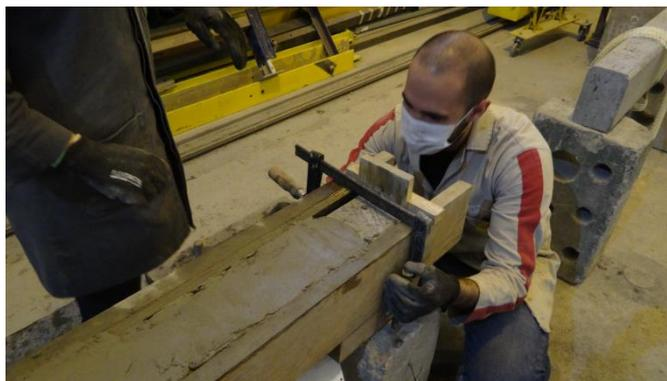
Após o posicionamento das vigas e do sistema limitador de camadas, dava-se início à etapa de preparação da mistura. A umidade, a temperatura do ambiente e outras informações, como horário de início e de fim da mistura e do reforço, foram registradas.
