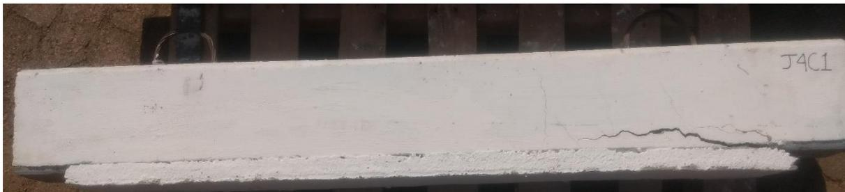
**Figura 98** – Viga J4C2 após ruptura por laminação do cobrimento do concreto.
