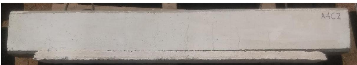
**Figura 90** – Viga A3V1 após ruptura por falha na interface reforço-viga.
