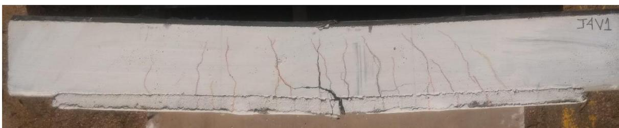
Com a finalidade de apresentar o modo de ruptura das vigas, foi elaborada a Tabela 21. A Figura 101 (a, b e c) apresenta as rupturas, respectivamente, por deslizamento do têxtil na matriz,
