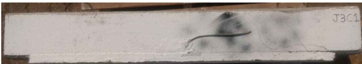
**Figura 96** – Viga J3C2 após a ruptura por deslizamento do têxtil na matriz.
