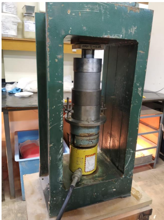
Figura 3.11 – Compactação do corpo de prova
