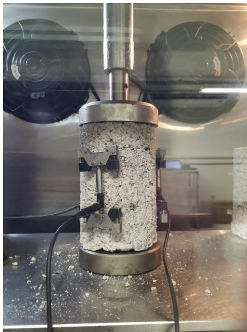
Figura 3.13 – Corpo-de-prova durante o ensaio de módulo dinâmico
