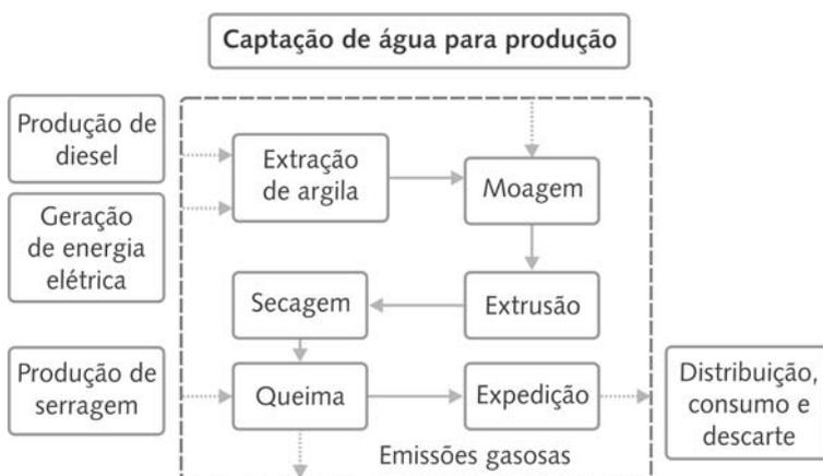
Figura 3 – Fluxograma-tipo da produção de tijolos
