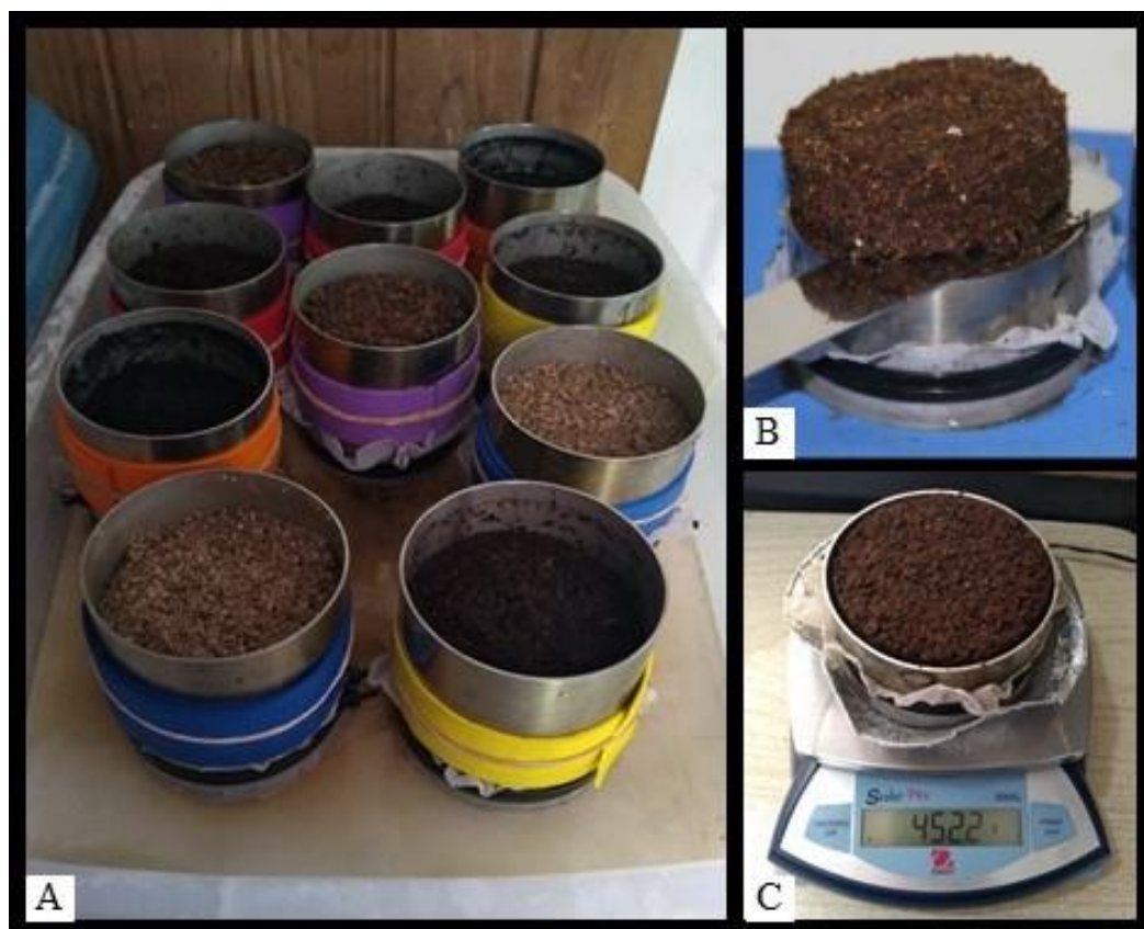
FIGURA 16. Conjunto de dois cilindros sobrepostos mantidos em leito de areia (A), separação do cilindro superior (B) e pesagem do cilindro inferior (C).
