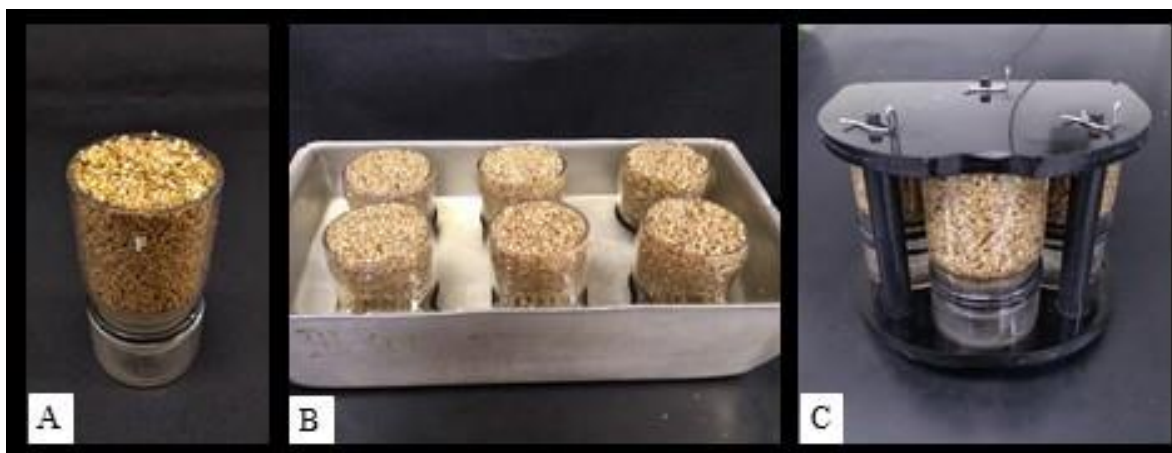
FIGURA 22. Preenchimento dos cilindros de vidro com capacidade de 60,96 \text{ cm}^3 , contendo um reservatório coletor de água em sua base (A), cilindros mantidos em água (B) e suporte para o conjunto de cilindros (C), o qual foi acoplado em rotor de placas da centrífuga Eppendorf (modelo 5804R).
