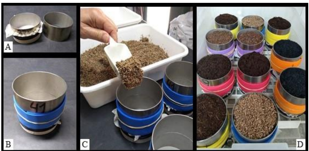
FIGURA 15. Conjunto de dois cilindros sobrepostos de 5 cm de altura e 10 cm de diâmetro (A-B) preenchidos com os materiais após padronização da umidade inicial das amostras (C) e mantidos em água durante 24 horas (D).
