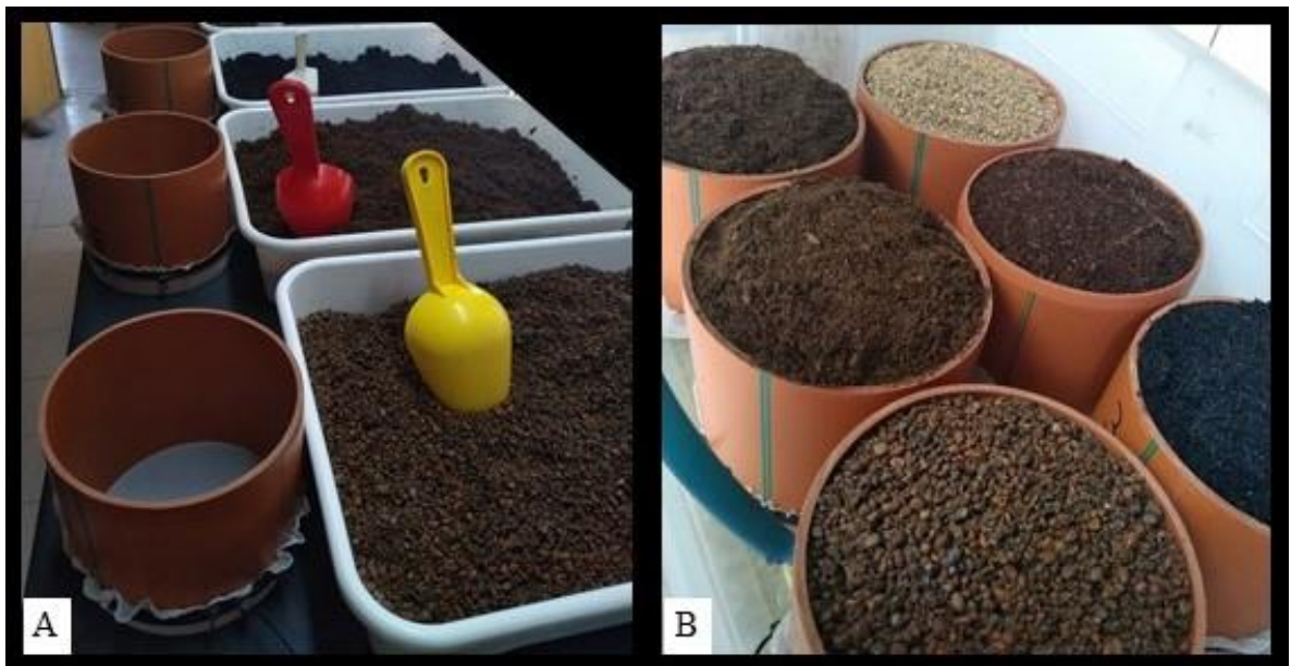
FIGURA 14. Amostras dos materiais colocados em cilindros com capacidade de 2 L (A) e mantidos em água durante 24 horas (B).
