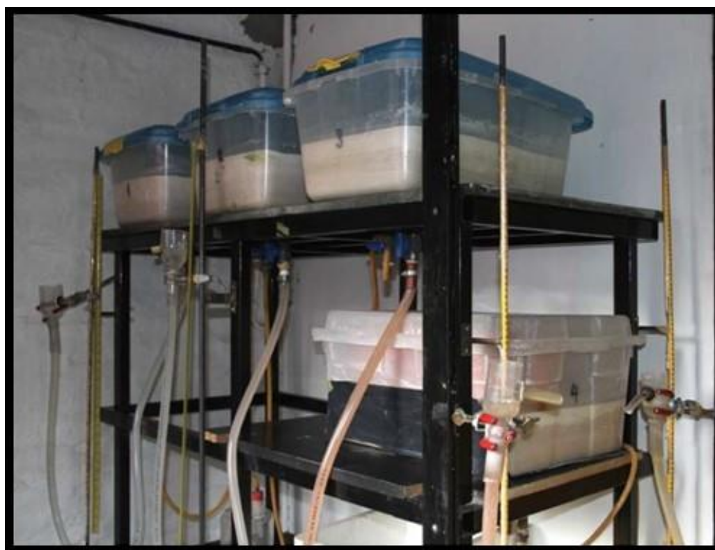
FIGURA 13. Equipamentos do tipo leito de areia, em que os três da estante superior são utilizados para tensionar até 100 hPa, e o da estante inferior para tensionar em 50 hPa para padronização da umidade inicial das amostras.
