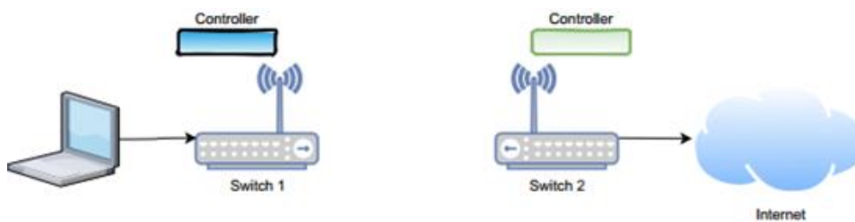
Figura 4.3: Representação do cenário 7 com 2 dispositivos low-end programáveis, 1 host e acesso à internet.
