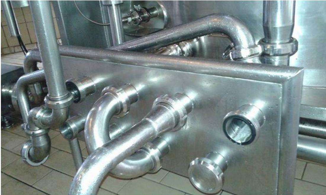
Figura 7: Imagem de uma Placa de Manobra de Tubulações (ITALIAINOX, 2021)
