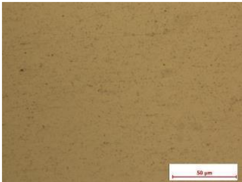
Figura 25. Ataque com solução de HF por 20s 500x CP04.
