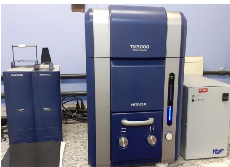
Figura 16. MEV Hitachi TM3000 de bancada.
