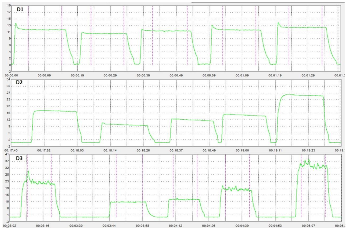
Figura 3. Comportamento das pressões geradas pelos dispositivos nos fluxos de 50, 10, 20, 40 e 70 L/min respectivamente. D1: válvula spring load ; D2: dispositivo pneumático artesanal; D3: coluna d'água.
