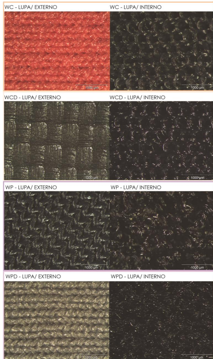
Figura 21. Lupa – Análise antes da ruptura – Parte Interna e Externa
