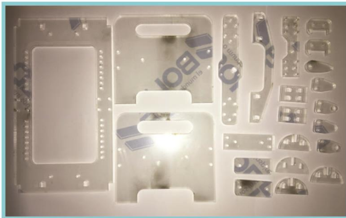
Figura 29. Aparato de Elasticidade – Peças cortadas à laser no acrílico
