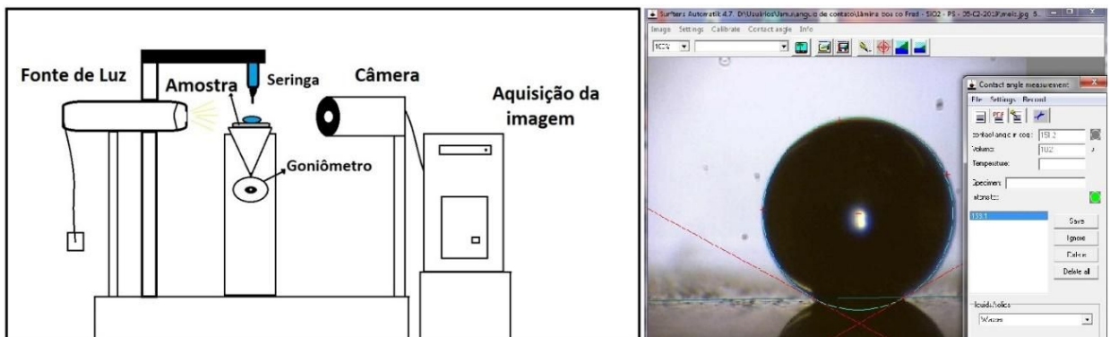
Figura 3.3: Na esquerda, o esquema representativo do equipamento para capturar a imagem da gota. Na direita, a imagem sendo usada no software que mede o ângulo de contato.
