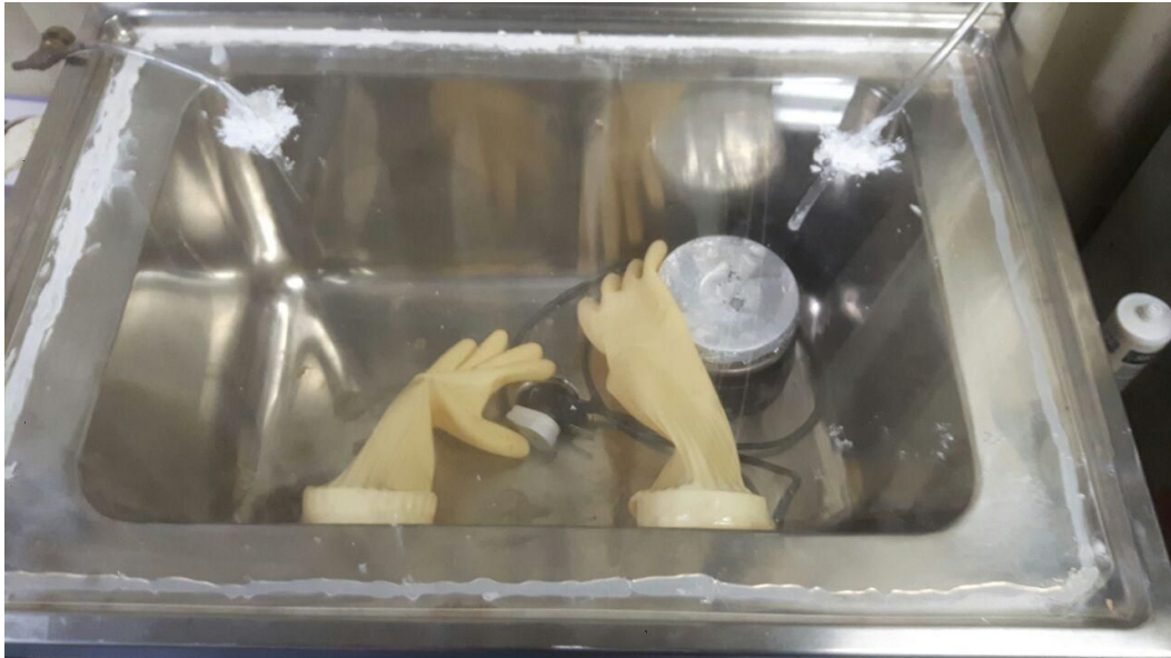
Figura 3.1: Glove box (caixa de luvas) do laboratório
