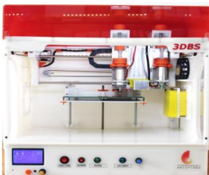
Figura 24. Bioimpressora 3D capaz de extrusar pellets e pó.
