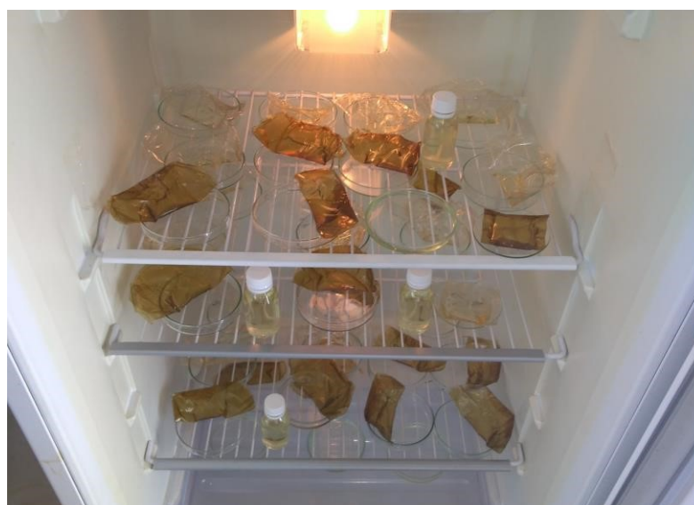
Figura 10 – Câmara contendo filmes biodegradáveis e controles aberto e fechado contendo óleo de girassol
