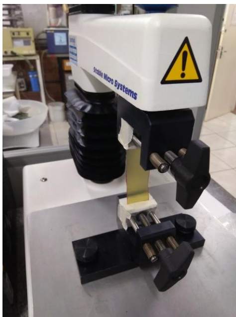
Figura 8 – Análise de propriedades mecânicas, texturômetro modelo TA.XT
