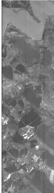
FIGURA 4.4 - Stripes na banda 11 (454,63 nm).
