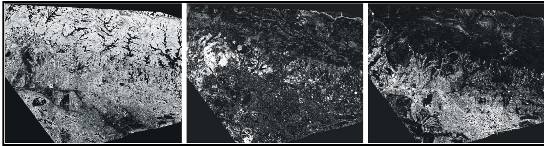
FIGURA 2.37 - Exemplo de imagens fração resultante de um modelo com quatro MRs (GV+NPV+Solo+Sombra). Da esquerda para direita: Imagem fração vegetação verde (GV), imagem fração vegetação seca (NPV) e imagem fração solo.
