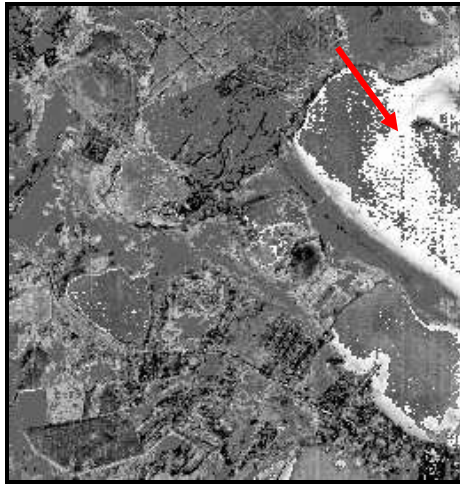
FIGURA 5.23 – Imagem fração Sombra de porção da cena, indicando pixels da classe Água com Sedimento modelados com alta fração de sombra (aproximadamente 70%).
