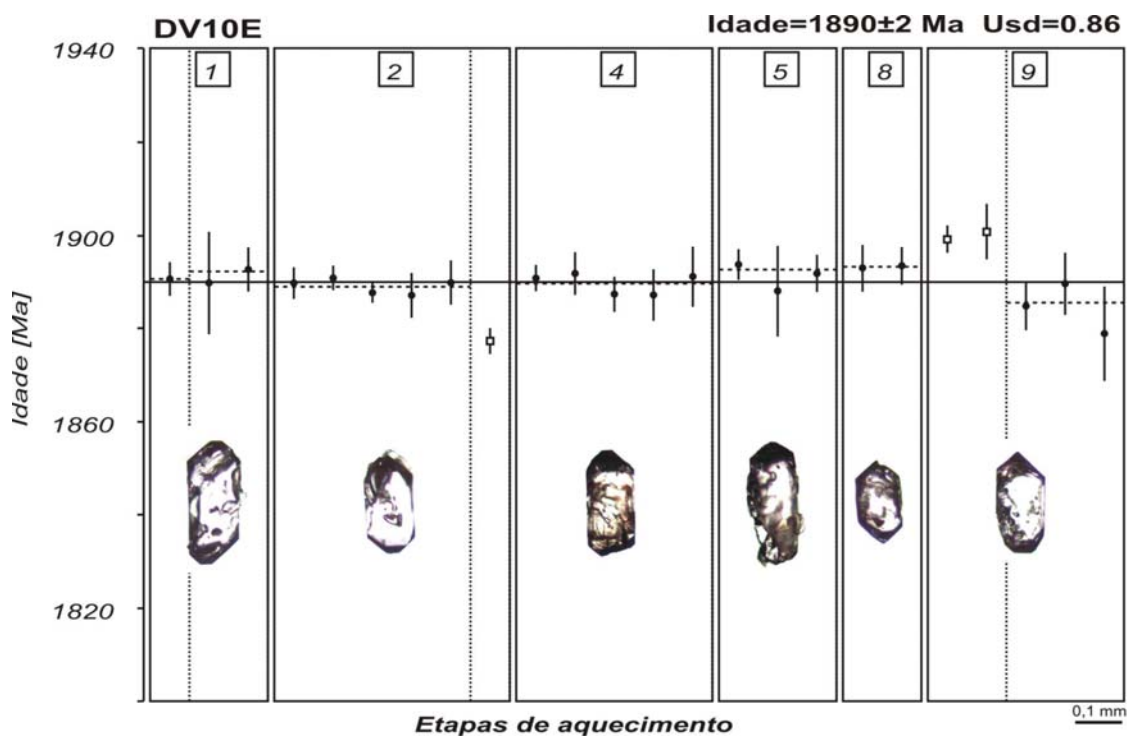
Figura 9 - Diagrama de idade Pb-Pb em zircão para a amostra DV10E (ignimbrito riolítico). Ordenada: idades (Ma) vs. abscissa: etapas de aquecimento e número do zircão. Obs.: ● Blocos de razões isotópicas utilizadas; □ Bloco eliminado subjetivamente; x bloco eliminado com razão ^{204}\text{Pb}/^{206}\text{Pb} > 0,0004 . Desvio analítico de 2 sigma.
