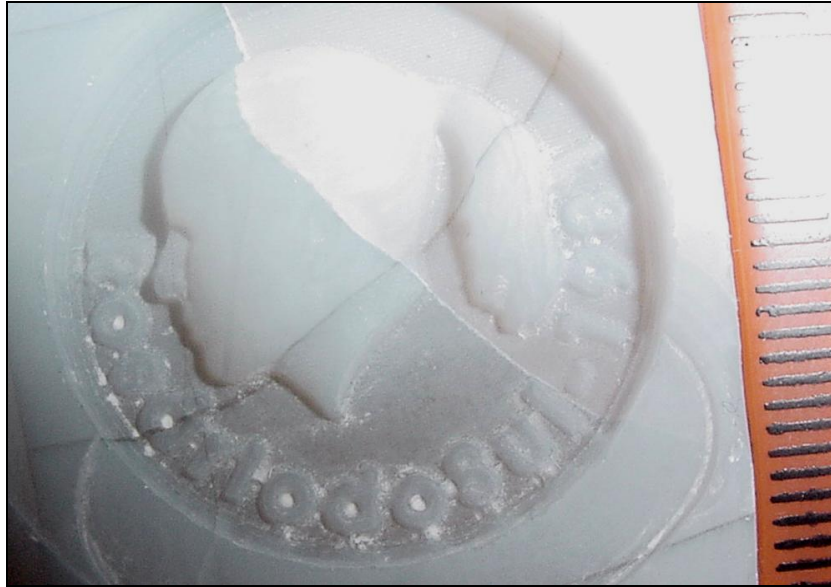
Figura 37. Imagem de perfil feminino usinado em amostra de opala branca e ágata. Fonte: Autor
