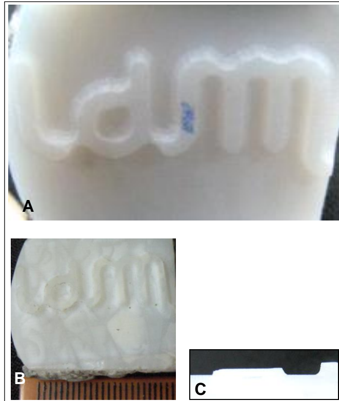
Figura 34. Em (A) e (B), vista de topo do texto reproduzido em alto relevo na opala e em (C), vista lateral, revelando a altura do texto.
