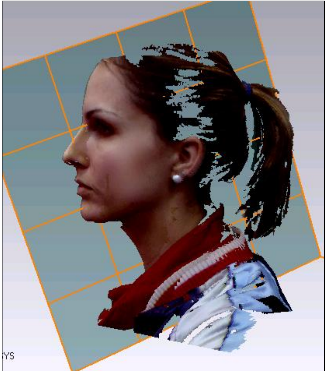
Figura 29. Imagem nas cores originais fotografada pelo scanner a laser 3D móvel.
