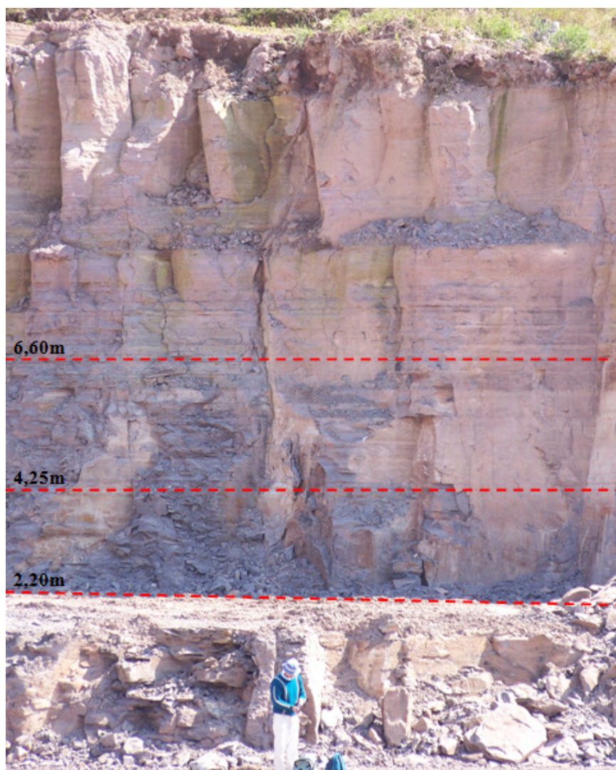
Figura 14 - Frente da lavra onde foram coletadas as 14 amostras nas diferentes alturas do perfil da mina de Turvo.
