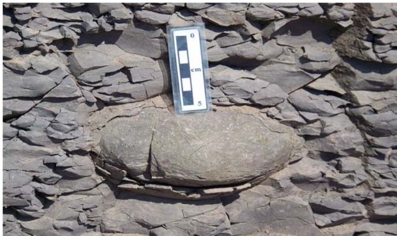
Figura 13 - Fraturamento conchoidal e uma concreção da mina de Turvo.
