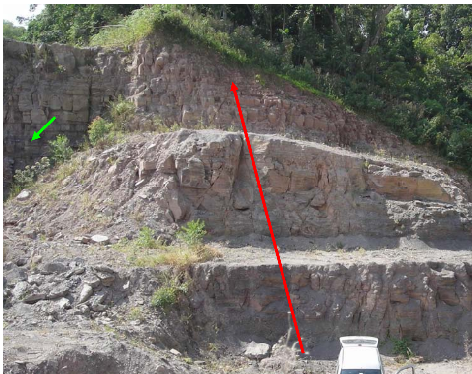
Figura 18 - Local onde foram retiradas as 22 amostras da base até o topo (no percurso da seta vermelha) e das lentes de calcário (seta verde) no perfil da mina de Meleiro.
