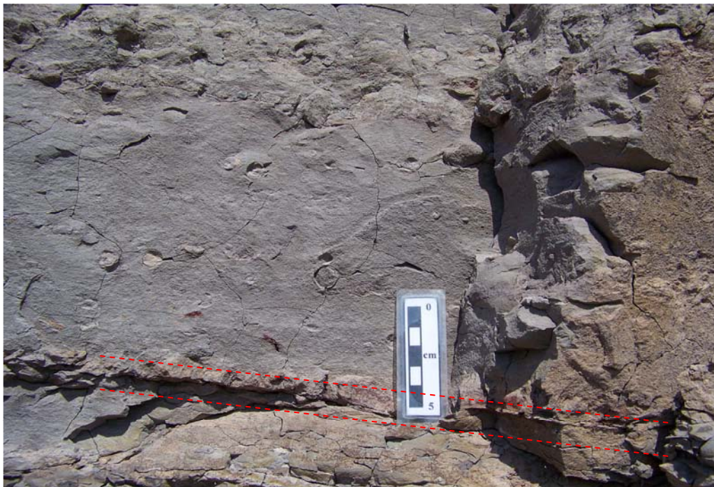
Figura 11 - Nível contínuo de oxidação numa matriz maciça da mina de Turvo.
