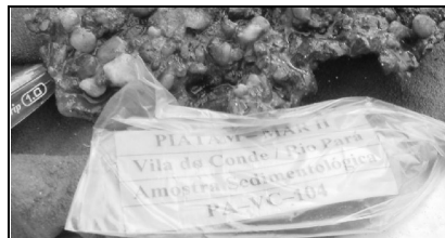
Figura 09: Concreção laterítica coletada em amostra de canal.
