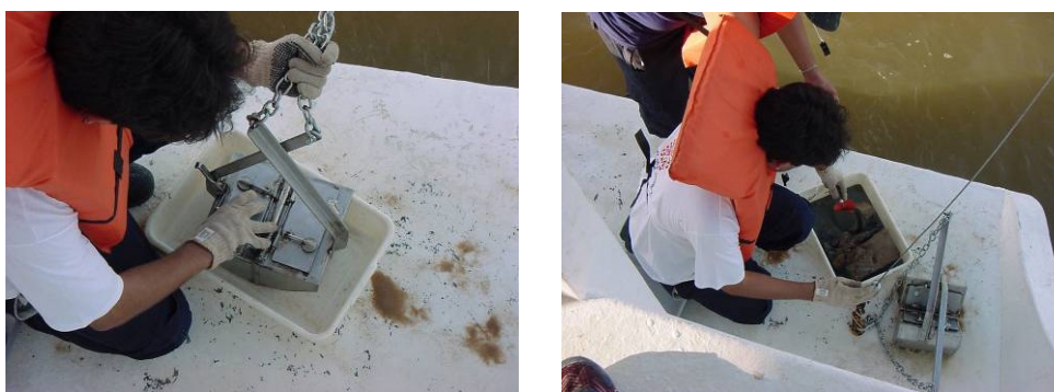
Figura 12: Abertura do amostrador em basqueta de acrílico; (B) Subamostragem para análises sedimentológicas e mineralógicas.
