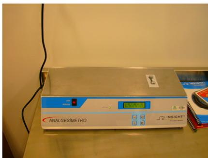
**Figura 5.** Analgesímetro para avaliação de latência de retirada da cauda.
