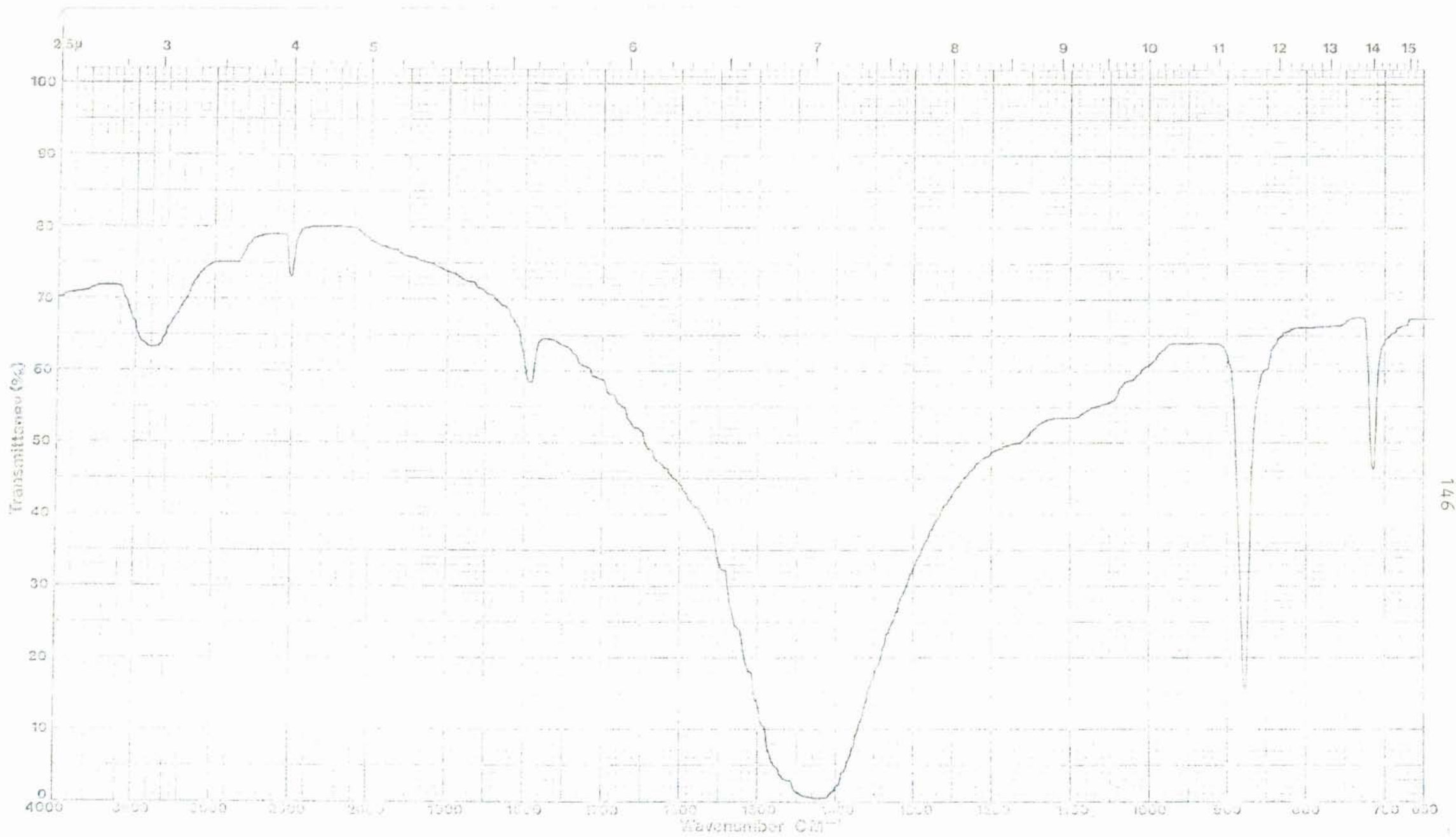
Figura 12 - Espectro da Calcita/Superfloc - Pastilha KBr, a 1%.
