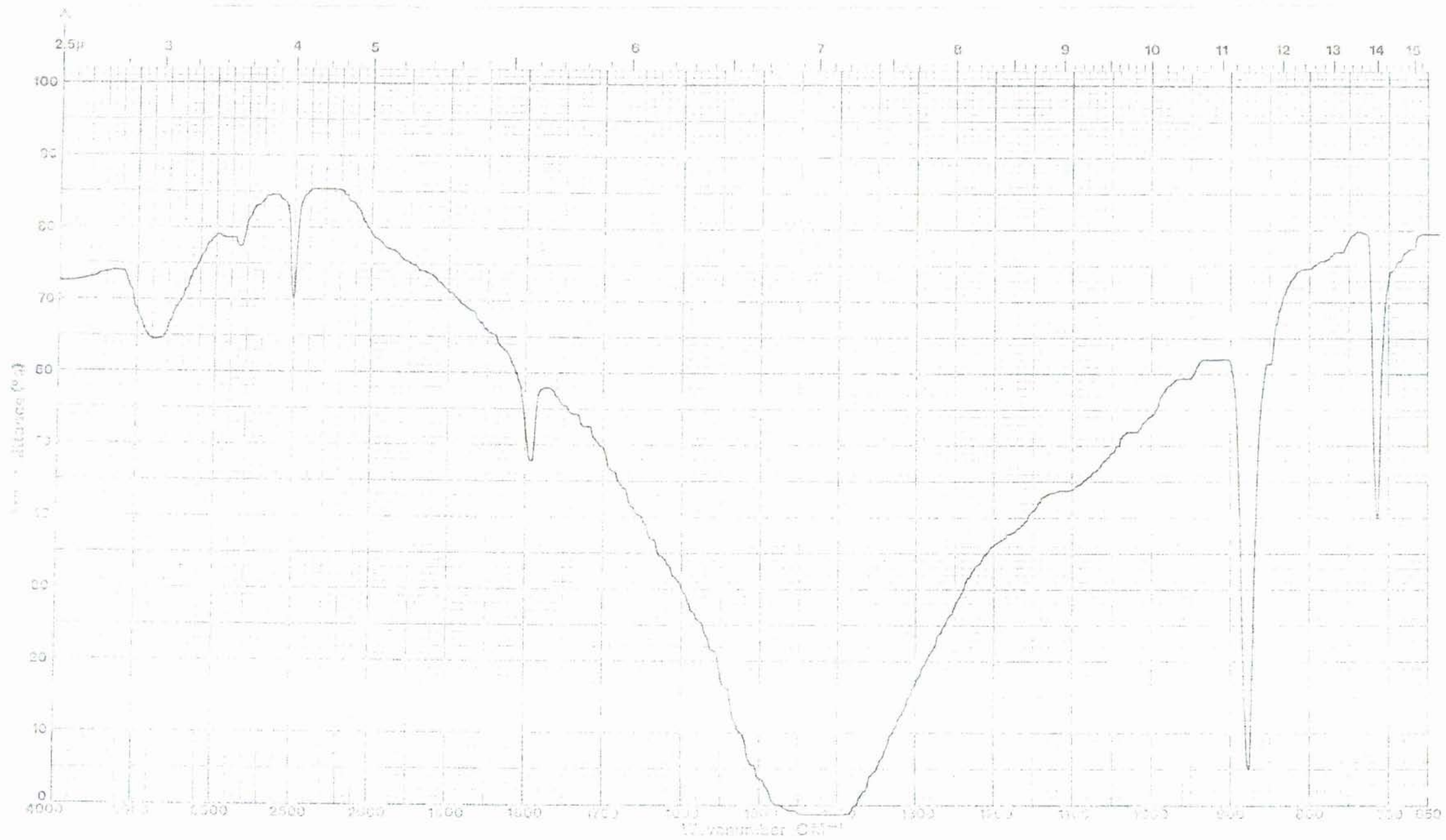
Figura 10 - Espectro da Calcita/Cyquest. Pastilha KBr, a 1%.
