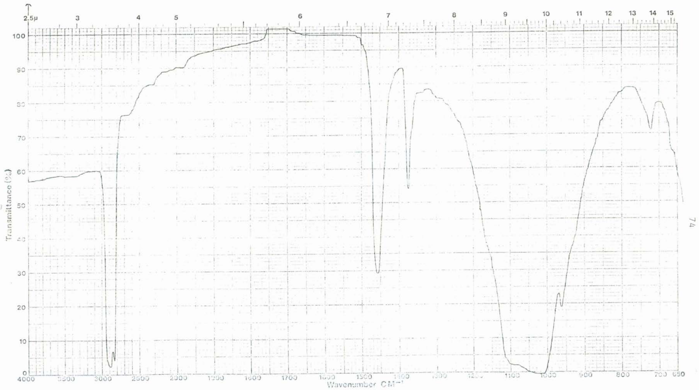
Figura 23 - Espectro da apatita. Solvente Nujol, filme sem NaCl.
