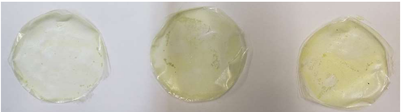
Figura 10. Filmes F6 NE Vit obtidos após processo de secagem em estufa a vácuo a 40 °C após 24 horas.
