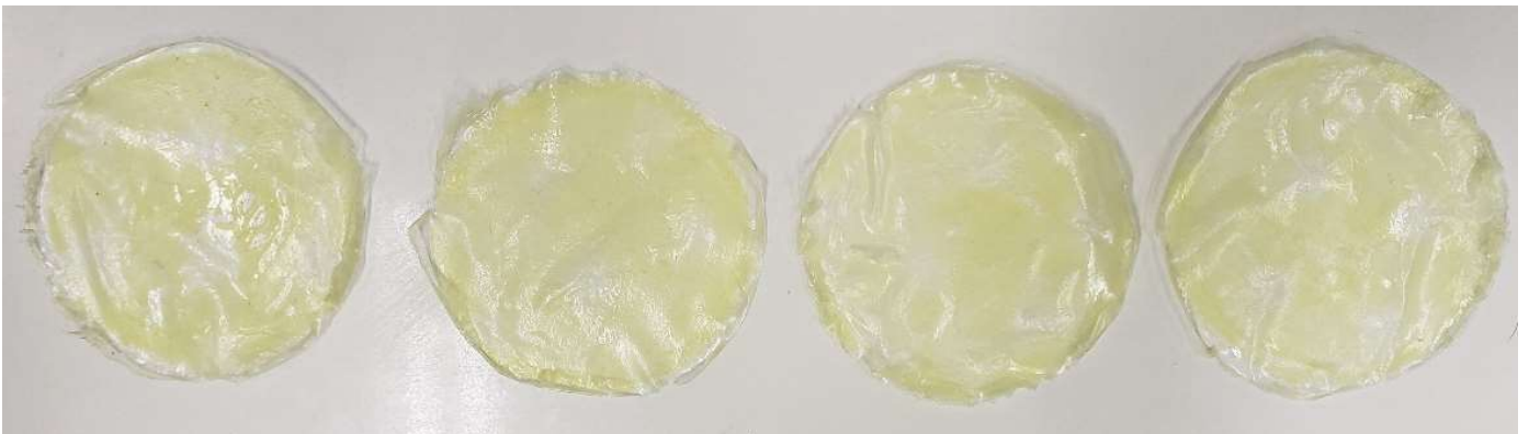
Figura 9. Filme F6 NC Vit obtido após processo de secagem em estufa a vácuo a 40 °C após 24 horas.
