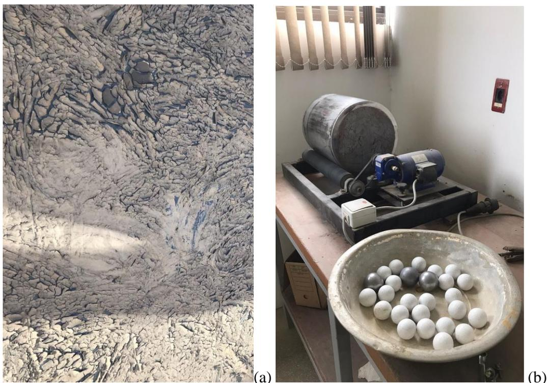
Figura 3.15 – (a) Secagem e (b) destorroamento do solo (AUTORAL, 2021).
