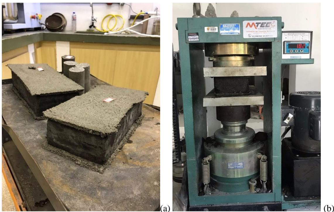
Figura 3.32 – (a) capeamento e (b) rompimento dos BTCs (AUTORAL, 2021).
