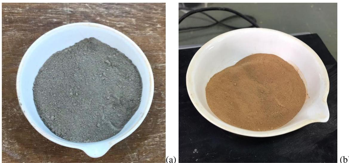
Figura 3.10 – Solo (a) antes e (b) depois do ensaio de teor de matéria orgânica (AUTORAL, 2021).
