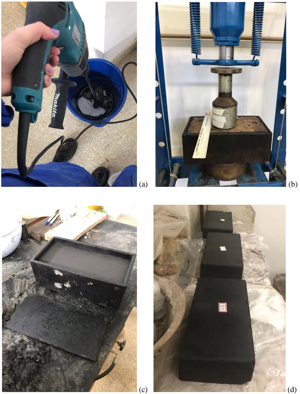
Figura 3.30 – (a) Mistura, (b) compactação, (c) fôrma e (d) cura dos BTCs (AUTORAL, 2021).
