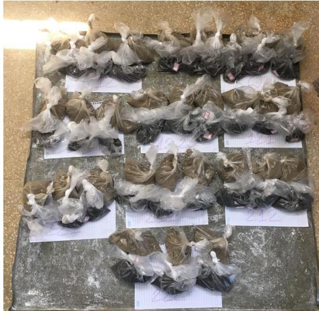
Figura 3.21 – Materiais sólidos separados para mistura e moldagem (AUTORAL, 2021).
