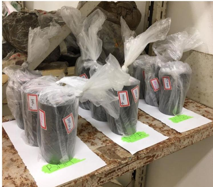
Figura 3.25 – Cura dos corpos de prova cilíndricos (AUTORAL, 2021).
