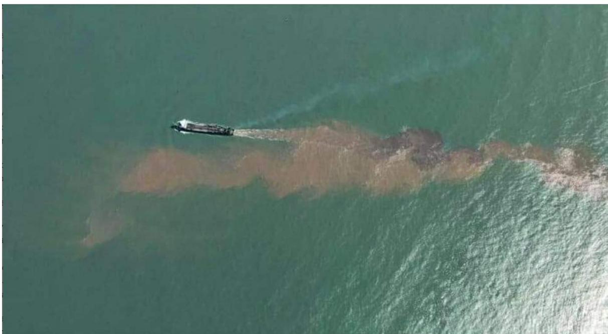
Figura 2.4 - Utilização de *overflow* na dragagem do canal do Porto de Rio Grande em 2018 (FERREIRA; FREITAS; LUCENA, 2019).
