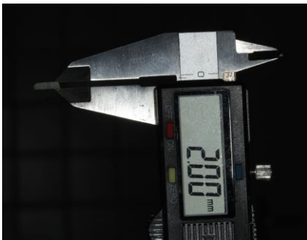
Figura 7 – Verificação da espessura da amostra de esmalte/dentina com o paquímetro.
