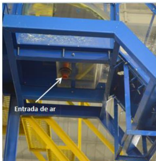
Figura 5.3. Foto das instalações e esquema do sistema de indução de ar do Modelo LOH II, sendo (a) um corte transversal e (b) uma vista frontal da região da crista. Cortesia de Carolina Novakoski.
