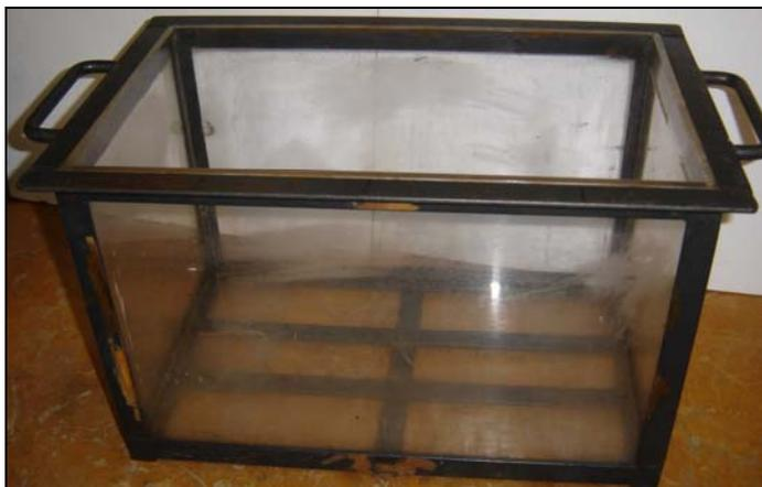
Figura 3.4: Tanque retangular com paredes em acrílico.
