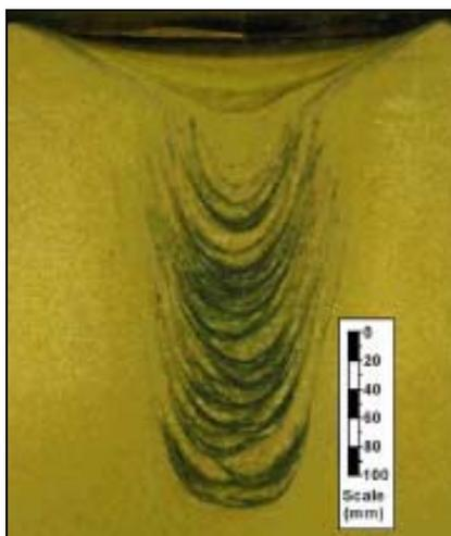
Figura 2.18: Fotografia de uma barreira reativa de ZVI instalada através da técnica de fluidização em um tanque preenchido com areia (Niven, 2001).
