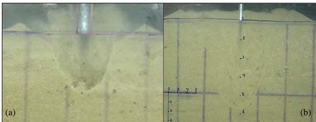
Figura 4.10: Fotografias da zona fluidizada para  $H=0\text{mm}$  (estágio de iniciação): (a) ensaio A26 (areia fina,  $d_j=7,85\text{mm}$ ;  $U_0=0,55\text{m/s}$  e  $Fr_p=10,3$ ); (b) ensaio A19 (areia fina,  $d_j=3,85\text{mm}$ ;  $U_0=2,29\text{m/s}$  e  $Fr_p=42,8$ ).
